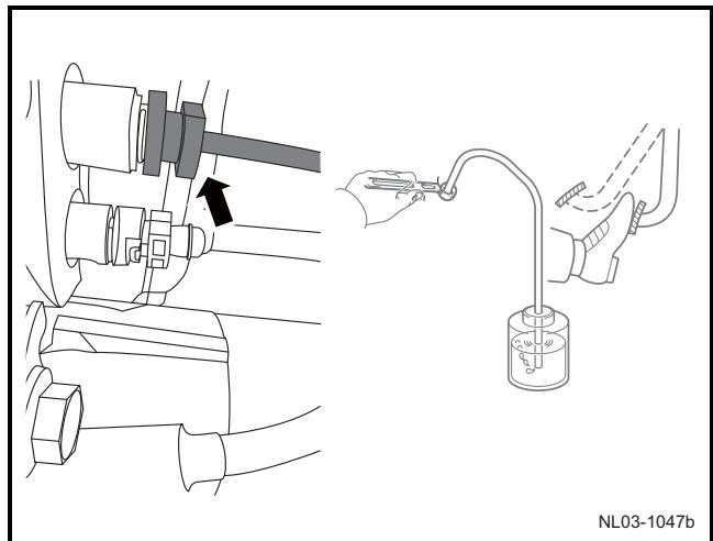
2) 拆卸分离轴承与液压软管连接的 U 型夹, 脱开分离轴承与液压软管的连接。
