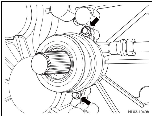
2) 安装分离轴承与变速箱连接的两个固定螺栓。
