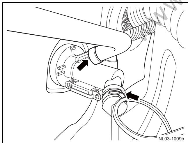
2) 拆卸离合器液压软管和总泵进油软管。
